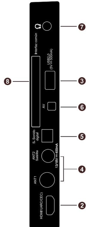
**6. AV:** Conjunto de conectores de entrada de Audio y Video, para conectar cualquier dispositivo utilizando la señal de video compuesto normal y los canales estéreo analógico izquierdo y derecho. El color de los conectores son los siguientes:
