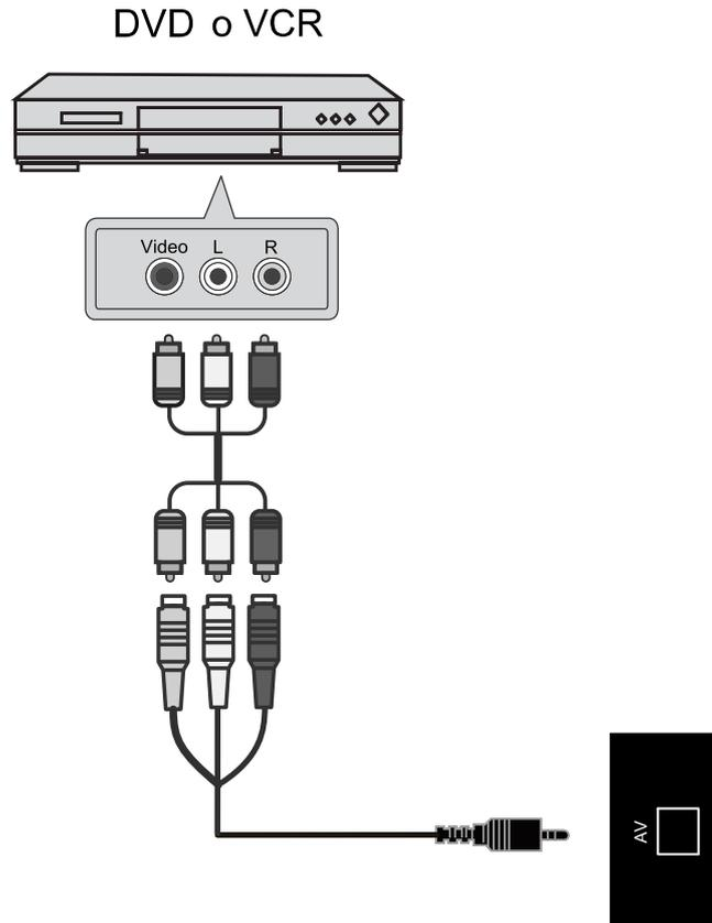
1. Utilice el cable AV in para conectar los conectores de salida del dispositivo de audio / video externo a la conexión YPbPr de su televisor LED. Utilice un cable de audio para conectar los conectores de salida de audio de su dispositivo de audio / video a la conexión de audio AV L y R de su televisor LED.
