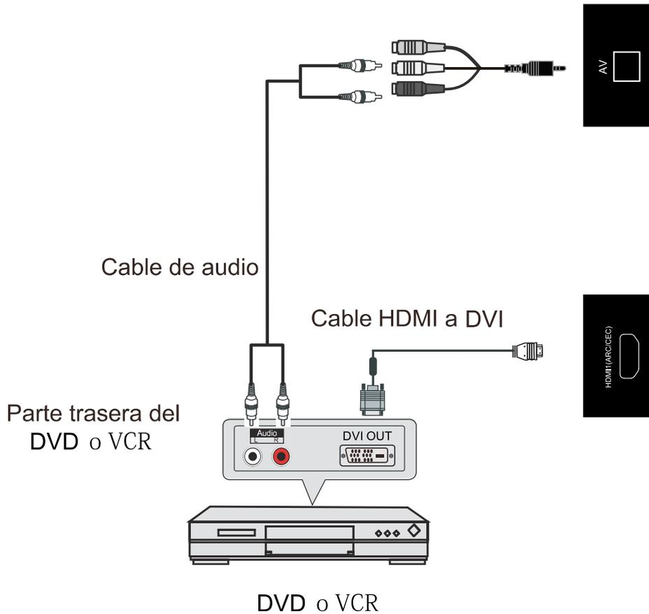
1. Utilice un cable de HDMI a DVI para conectar los conectores de salida DVI de su dispositivo a la conexión HDMI de su televisor LED.
