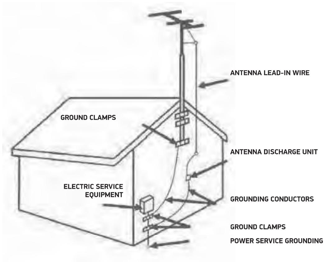
**Ground clamps:** Abrazadera de conexión a tierra.
