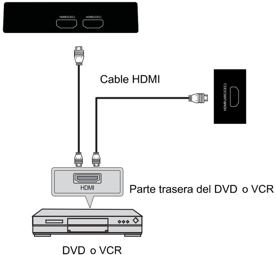
1. Utilice un cable HDMI para conectar los conectores de salida HDMI de su dispositivo a la conexión HDMI de su televisor LED.
